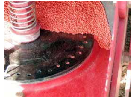
は種盤（穴の直径は3.5～4mm 2粒播き、穴の数は20～30）
