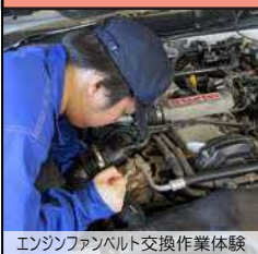
エンジンファンベルト交換作業体験
