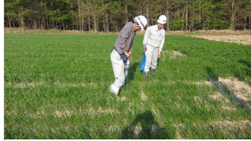
上: 貫入式土壌硬度計による耕盤層の確認 右: 土壌硬度結果
