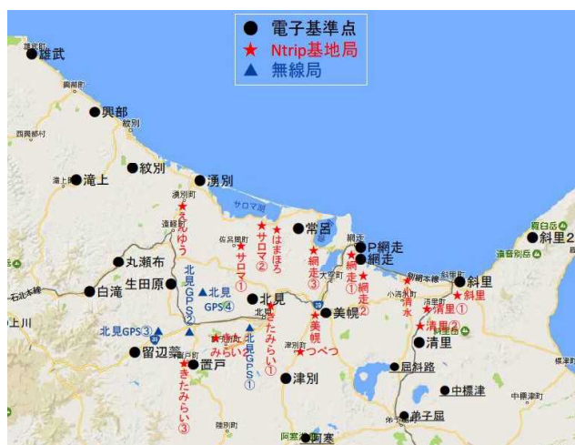
オホーツク管内におけるRTK基地局に設置状況 (H29年10月現在、オホーツク農協連調べ)
