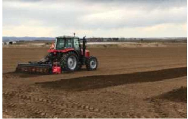
4本飛ばしての碎土・整地作業。正確に作業ラインに進出し、旋回にかかる時間は24秒
