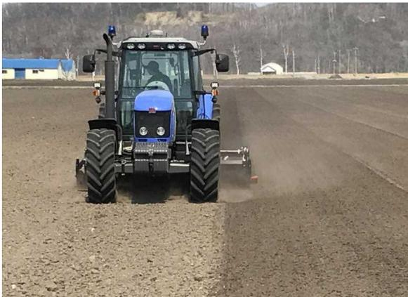
ガイダンスシステム・自動操舵補助装置を用いた場合、作業軌跡の蛇行なく、掛け合わせはごくわずか
