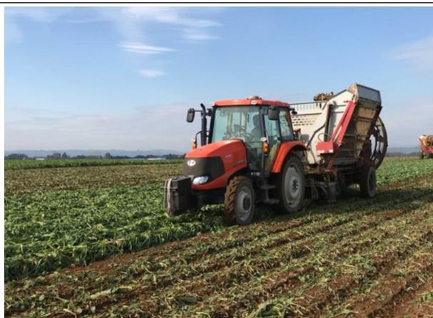
ガイダンスシステム・自動操舵補助装置を用いて移植したてんさいほ場。収穫ロスなく高速での作業が可能となる(車速は13~14km/hr)
