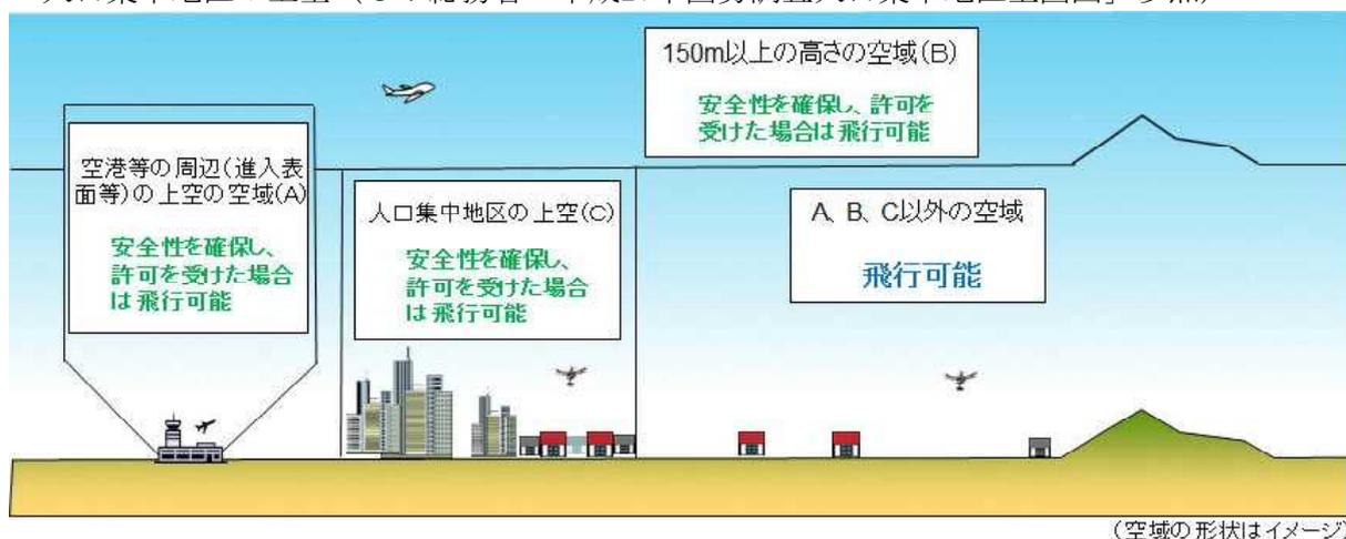
飛行可否の区分（出典：無人航空機（ドローン、ラジコン機等）の安全飛行のためのガイドライン）
