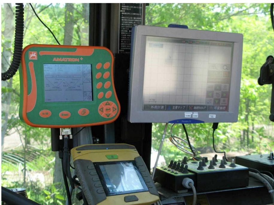
可変施肥を制御するトラクターキャビン内の機器
