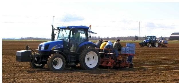
てんさいの移植作業にもガイダンスシステム・自動操舵補助装置が用いられ、2台同時の作業が可能。作業精度は高く、施肥位置との誤差は3cm以内
