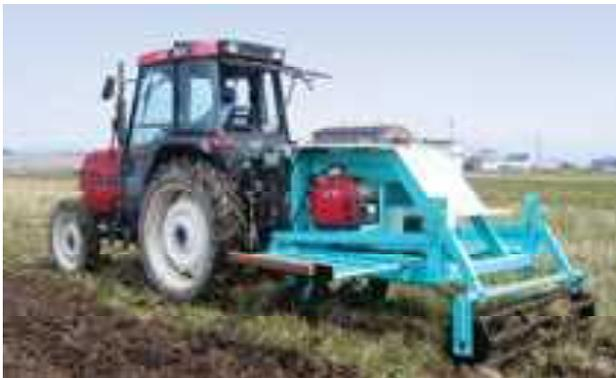
トラクター搭載型土壤分析システム
