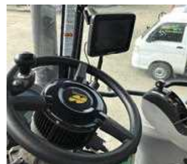
自動操舵補助装置 (トプコン社の電子ハンドル装備)
