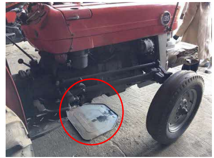
トラクターからのオイル漏れ対策 として鉄板を設置（津別町）
