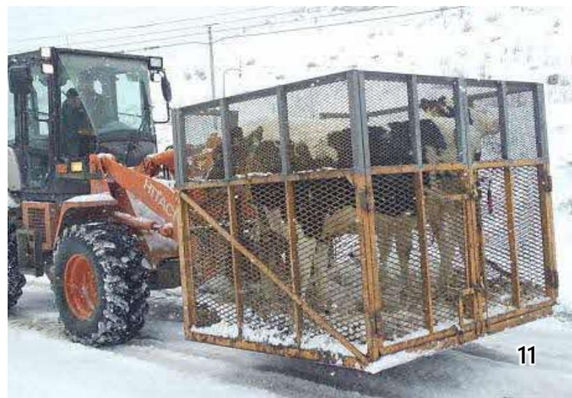
11. 牛を移動する際に利用する枠。トラクタで移動する。牛を安全に移動する道具（枠や柵など）はたくさんあった方が良い。
