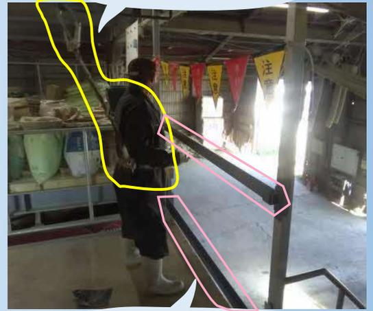
ゲートを解放して作業する時は転落防止用バーをセット
