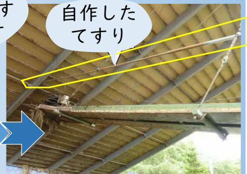
バークリーナーのミッション付近まで、丸パイプで手すりを自作して設置した
