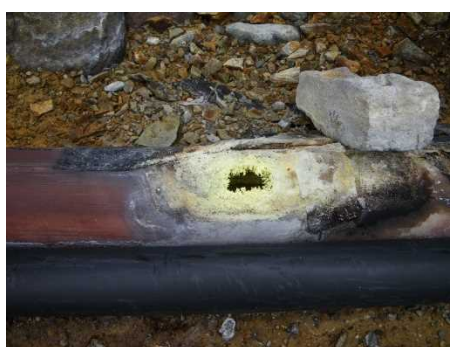
図 13 高濃度硫化水素を放出するガス抜き孔に析出した針状硫黄結晶
