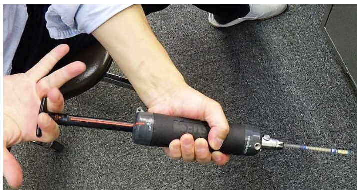
図 20 ストッパを解除しハンドルを引きながら戻す状況
