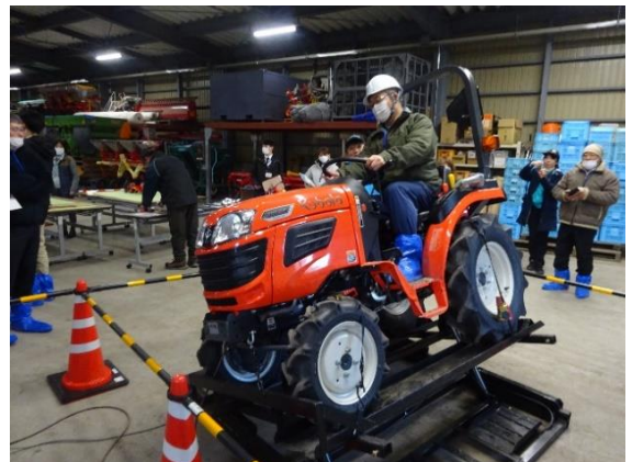
・トラクタ転倒角度体験及び シートベルト装着推進の様子
